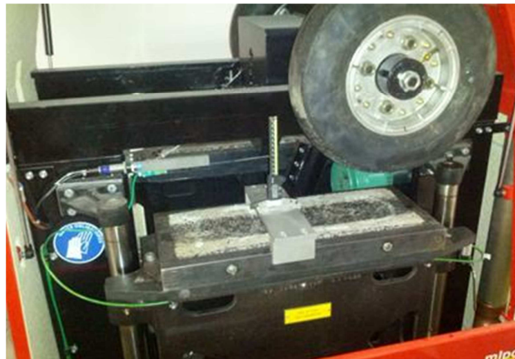
Figura 15 - Simulador de tráfego francês. Empregado para avaliar a deformação permanente de misturas asfálticas
