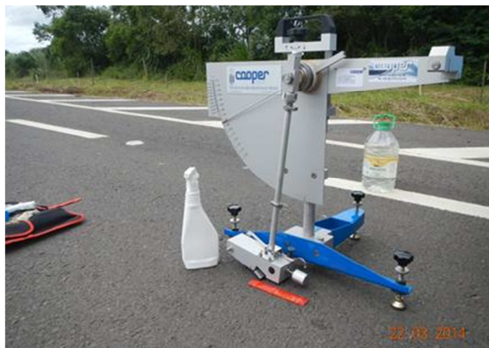
Figura 20 - Pêndulo Britânico sendo utilizado para a medição da microtextura do revestimento asfáltico aplicado nos Segmentos Monitorados de Araranguá
