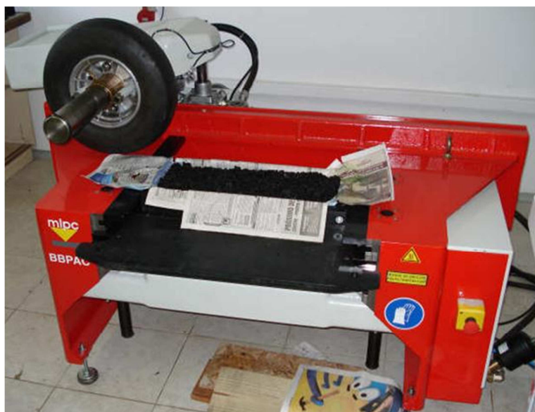
Figura 7 - Mesa compactadora de placas para obtenção de corpos de prova para ensaios de fadiga e deformação permanente (equipamento francês).
