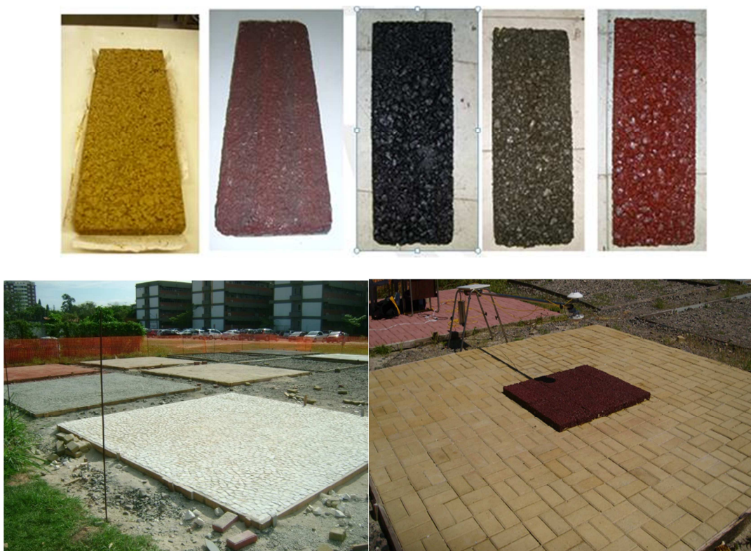
Figura 18 - Misturas asfálticas coloridas estudada para diminuir a ilha de calor urbano
