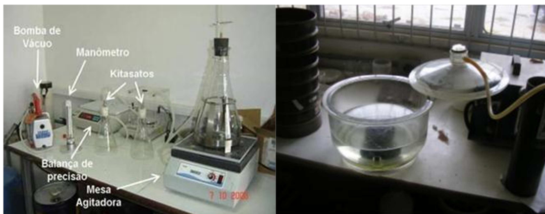
Figura 5 - Equipamento RICE para determinação da DMM e equipamento para a realização do ensaio de Dano por Umidade Induzida
