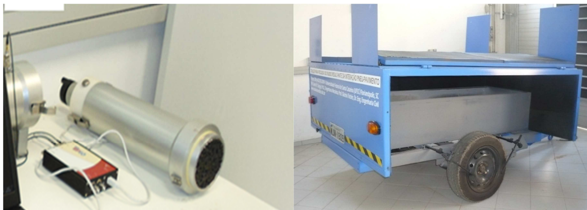
Figura 8 - Tubo de Impedância e trailer construído com o projeto CT-transporte
