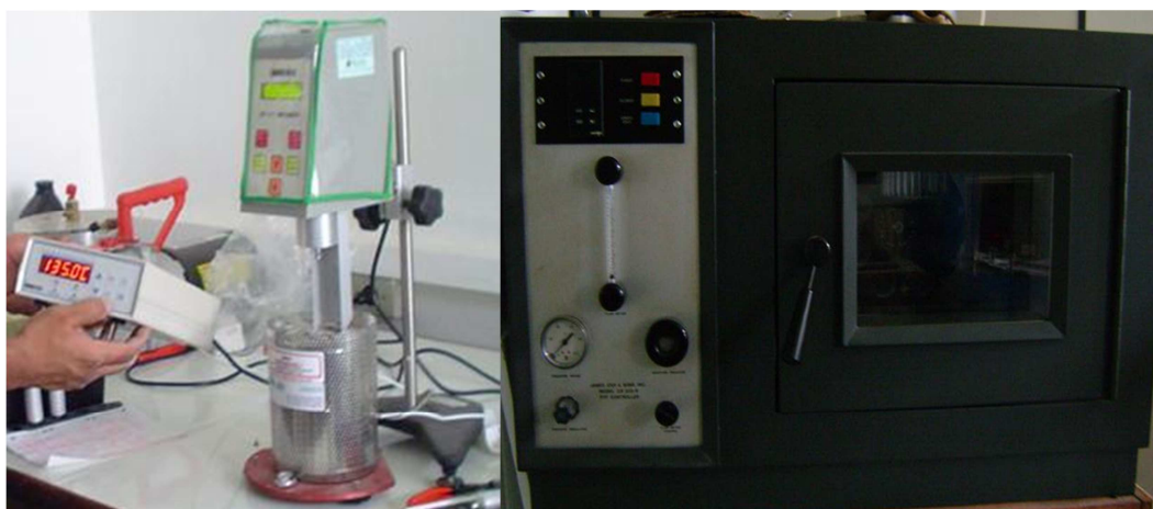
Figura 4 - Viscosímetro rotacional Brookfield de simulador do envelhecimento RTFOT
