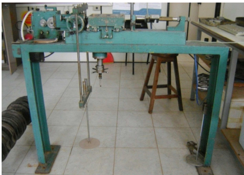
Figura 1 - Máquina de cisalhamento direto de solos. Primeiro contato com equipamentos de medição de propriedades geotécnicas de solos
