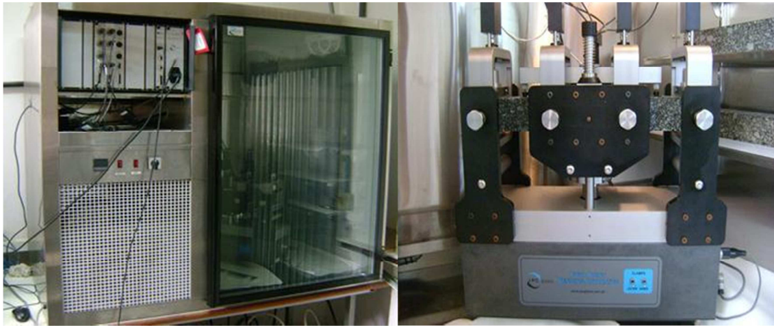
Figura 16 - Equipamento de fadiga 4 pontos. Empregado para avaliar o comportamento à fadiga de misturas asfálticas
