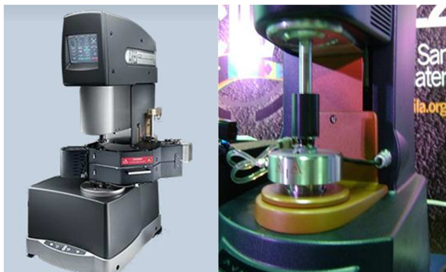
Figura 21 - Reometro de cisalhamento empregado para a caracterização do ligante
