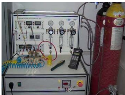
Bancada experimental PEMFC 15 W: Testes com hidrogênio - LabCET
