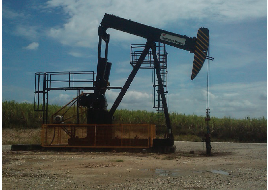
Figura 04. Bomba de vareta de sucção, popularmente conhecida como “cavalinho de pau”, utilizada na exploração de petróleo em terra, no município de Carmópolis/SE.
