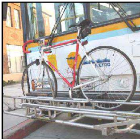
Figura 14 – Sistema de transporte de bicicletas fora do veículo
