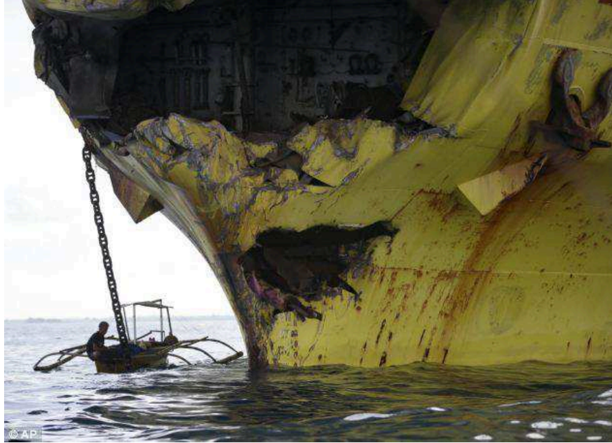
Figura 6 - Colisão frontal de um navio cargueiro com uma balsa nas Filipinas em 2013, o dano causado assemelha-se com o modo de colapso de eixo simétrico.
