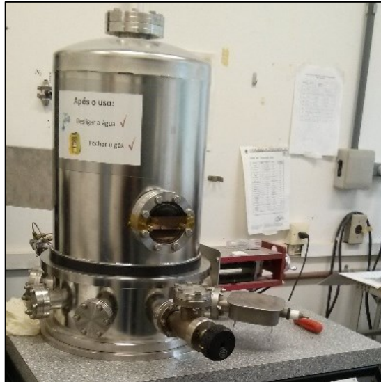
Figura 15 – Imagem ilustrativa do equipamento utilizado para a deposição de filmes finos pelo processo de feixe de elétrons.
