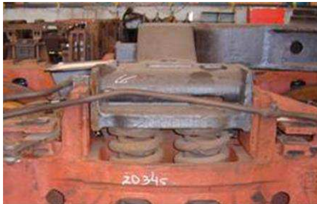
Figura 9. Ligação do bolster à estrutura do truque através de molas helicoidais.
