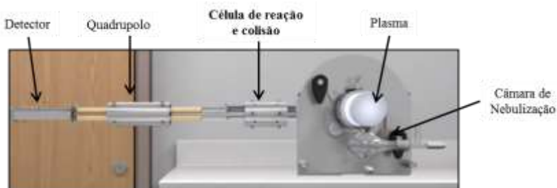
Figura 3. Esquema dos componentes básicos de um instrumento de ICP-MS com uma célula de reação e colisão
