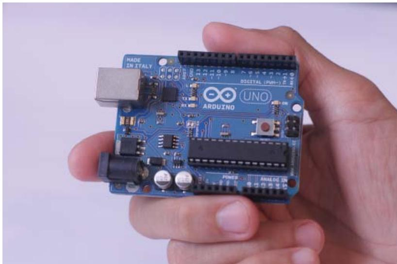
**Figura 34:** Placa Arduino, modelo UNO.
