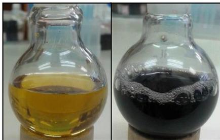
**Figura 15.** A esquerda solução contendo  $\text{K}_2\text{PdCl}_4$ , NaCl e ImS3-12. A direita dispersão coloidal contendo as NPs de Pd estabilizadas pelo surfactante ImS3-12, após redução.
