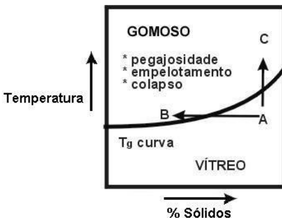
Figura 2.6. Diagrama representativo da transição de entre o estado vítreo e gomoso (LABUZA et al., 2004).
