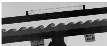
(a) Instabilidade de Kelvin - Helmholtz na interface entre dois líquidos (DYKE, 1982)
