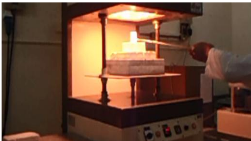
Figura 16 - Vazamento dos vidros
