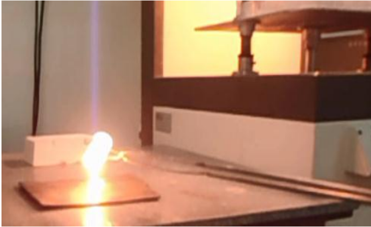
Figura 17 - Vazamento dos vidros
