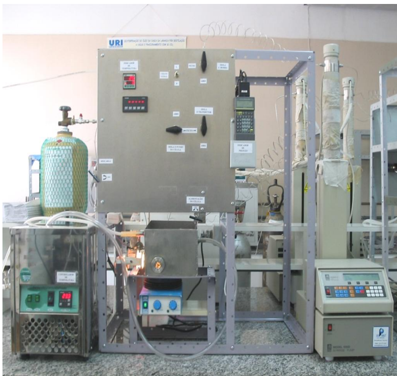
Figura 2.18 – Vista geral da unidade de equilíbrio de fases
