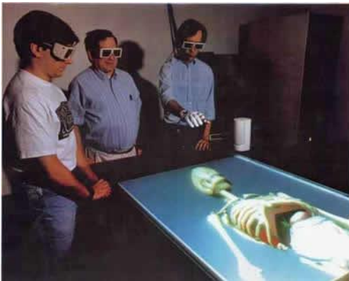
Figura 12 - RV de mesa, o esqueleto no monitor aparece como um objeto tridimensional
