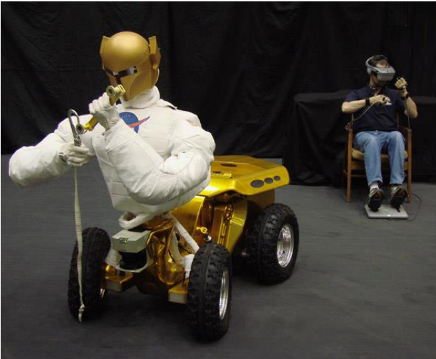
Figura 8 - Telepresença utiliza a RV para mergulhar visualmente o operador na área do robô
