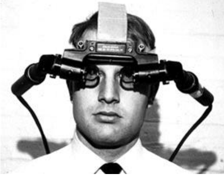
Figura 3 - Head-mounted display produzido por Ivan Sutherland
