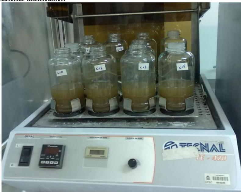
No ponto zero do experimento foram feitas análises de SST e SSV em cada frasco. Em seguida, foram retiradas alíquotas de  $15 \text{ mL}$  de cada frasco a cada  $45$  minutos até o tempo de  $315$  minutos. Foi medido
