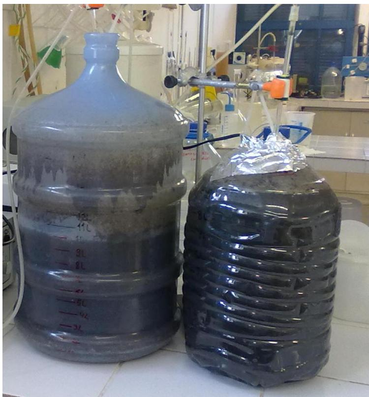
O enriquecimento das bactérias desnitrificantes e nitrificantes foi operado da mesma forma, em três etapas, conforme Tabela 5. Para partida dos reatores foram utilizadas inicialmente uma carga volumétrica de  $20 \text{ mg N.L}^{-1}.\text{dia}^{-1}$  (Etapa 1), sendo feita uma progressão de carga subsequentes nas Etapas 2 e 3, com o objetivo de aumentar a produção de biomassa dentro dos reatores.
