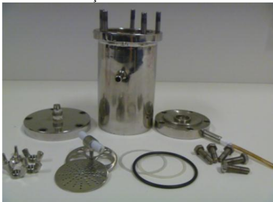
Figura 17: Célula de filtração desmontada utilizada durante os ensaios.
