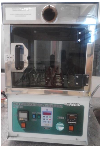
Figura 6: Incubadora Shaker com agitação orbital utilizado para a produção de biodiesel com gordura de suíno.
