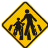
Figura 22 – Sinal A-33b - Passagem sinalizada de escolares
