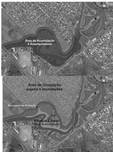
Figura 113 - Barragem de Proteção e Bacia de Amortecimento Parque Linear Itajaí-Mirim
