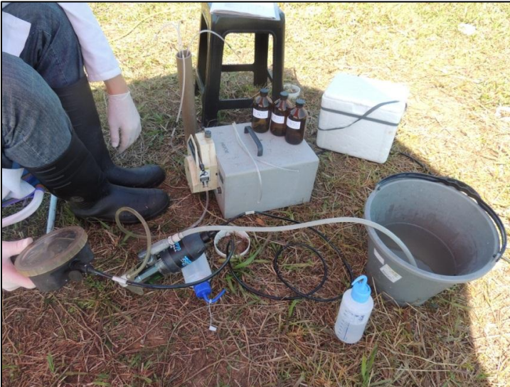
Figura 7 - Procedimento de coleta da água subterrânea com bomba peristáltica e análise em campo com Flow Cell .
