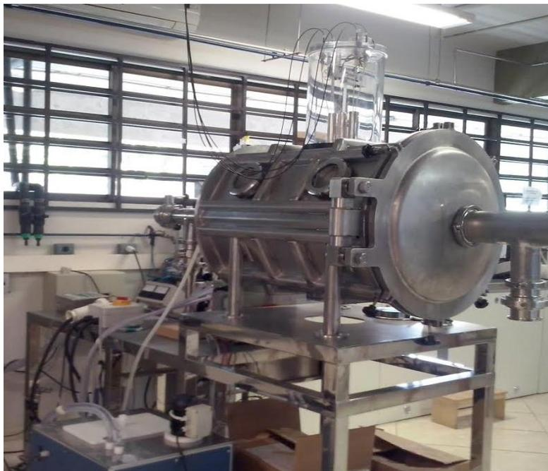
Figura 7. Secador de micro-ondas versátil, que pode operar em diferentes configurações.
