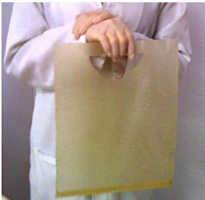
*Figura 8. Sacola de amido-fibras celulósicas-glicerol, formadas por termossoldagem de filmes preparados por tape-casting.*
