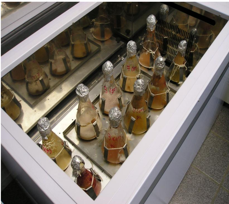
Figura 14 – Shaker orbital utilizado para os cultivos celulares de Monascus ruber CCT 3802
