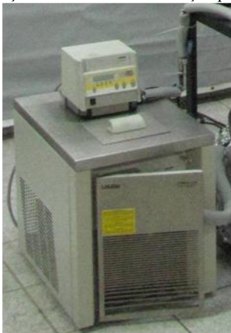
Figura 39: Fotografia do banho utilizado para controlar a temperatura da alimentação na unidade de destilação por película.
