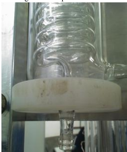
Figura 38: Fotografia do suporte do condensador.
