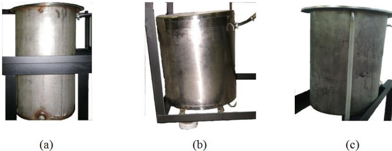
Figura 36: Fotografias: (a) do tanque mistura, (b) do tanque de alimentação e (c) do tanque acumulador.
