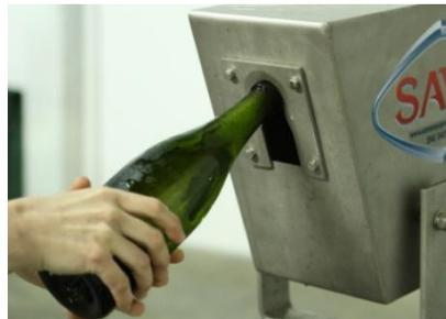
**2 ° Passo:** Retirada da tampa corona com auxílio de um Degorgiador
