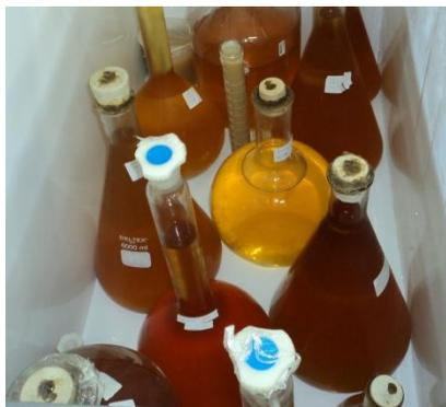
**Figura 6** – Sidras base acondicionadas em freezer (-3 °C) para clarificação e estabilização.
