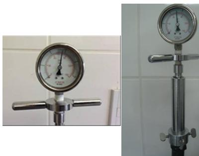
**Figura 15** – Manômetro adaptado com agulha à rolha para verificação da pressão nas garrafas.
