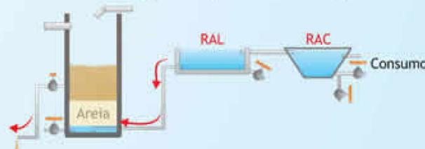
O nível de água dentro do filtro começa a baixar. A água escoou pela saída da água de lavagem. O RAC está cheio.
