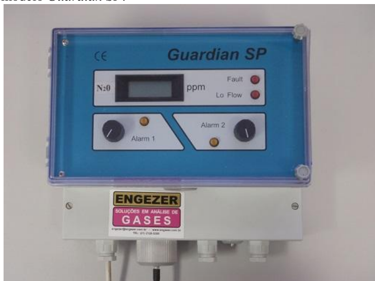
Figura 14 – Analisador de N_2O por raios infravermelhos, modelo Guardian SP .
