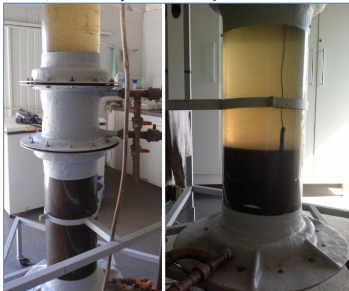
Figura 11 – Efluente tratado (sobrenadante) e biomassa granular (sedimentada), durante etapa de sedimentação do ciclo do RBSG.
