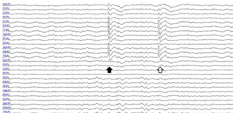
Figura 40 – Tela de 10 segundos de um traçado de EEG contendo descargas epileptiformes. Pode ser observado que houve a formação e a propagação de um campo de potencial elétrico para cada um dos eventos identificados pelas setas.
