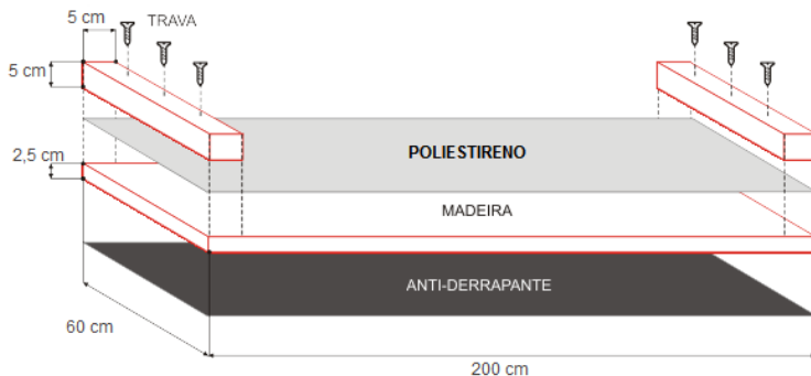
Figura 4. Ergômetro de patinação slide board.
