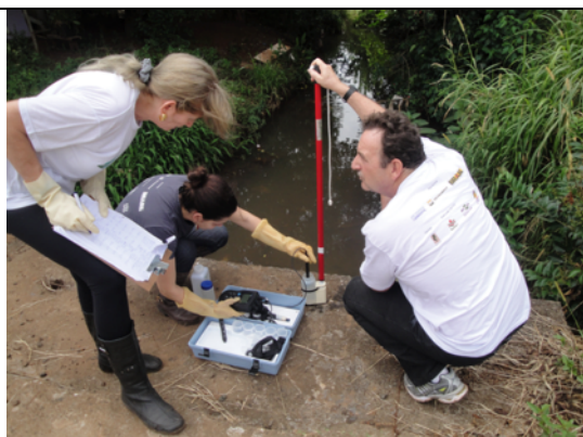
Imagem 37 - Coletas de água para diagnóstico da qualidade no Rio Passo dos Índios utilizando sonda e coletor de amostras.
