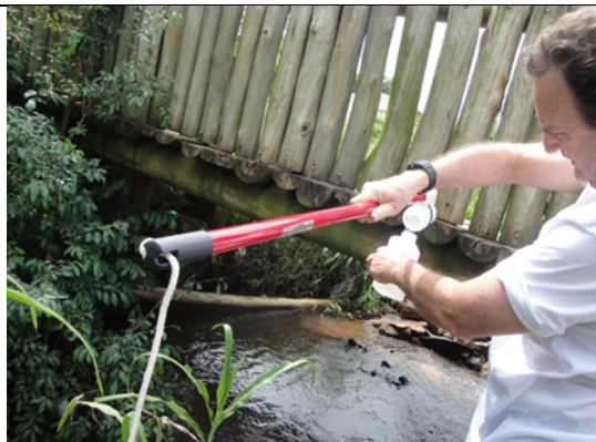
Imagem 35 - Coletas de água para diagnóstico da qualidade no Rio Passo dos Índios utilizando sonda e coletor de amostras.
