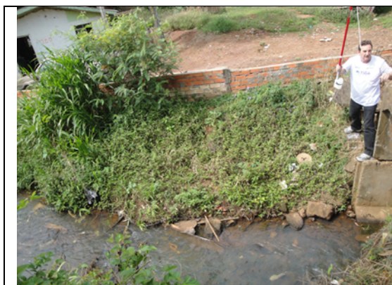
Imagem 32 - Coletas de água para diagnóstico da qualidade no Rio Passo dos Índios utilizando sonda e coletor de amostras.
