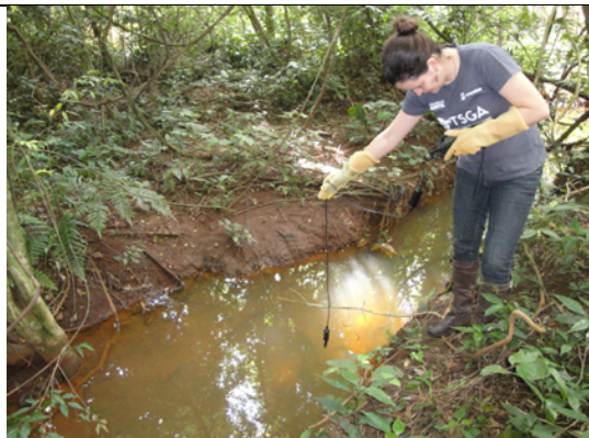
Imagem 34 - Coletas de água para diagnóstico da qualidade no Rio Passo dos Índios utilizando sonda e coletor de amostras.
