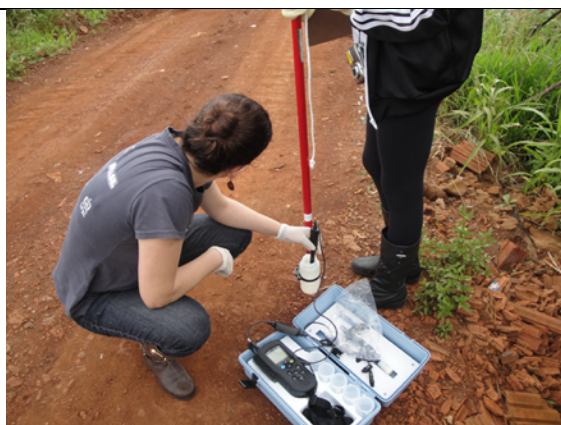
Imagem 31 - Coletas de água para diagnóstico da qualidade no Rio Passo dos Índios utilizando sonda e coletor de amostras.
