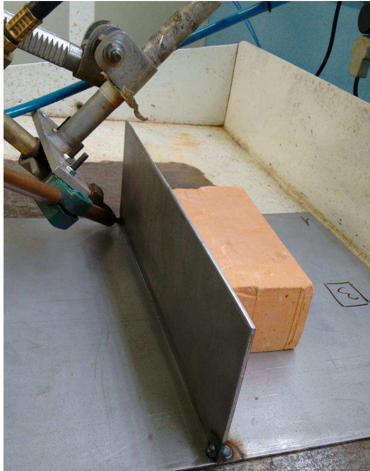
Figura 20: Corpo de prova alinhado com tocha de soldagem para ensaio
