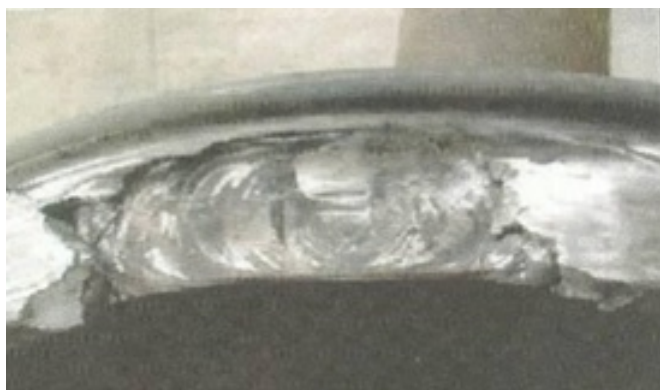
Figura 22 – Arrancamento encontrado em roda ferroviária.
