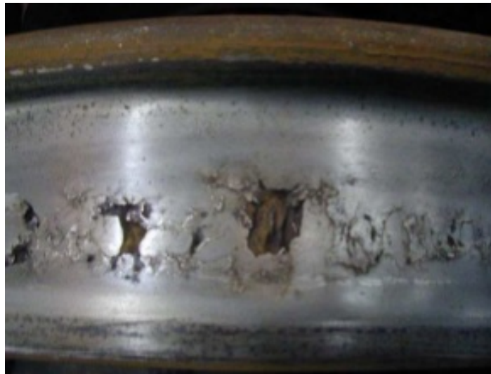
Figura 21 – Escamação encontrado em roda ferroviária.
