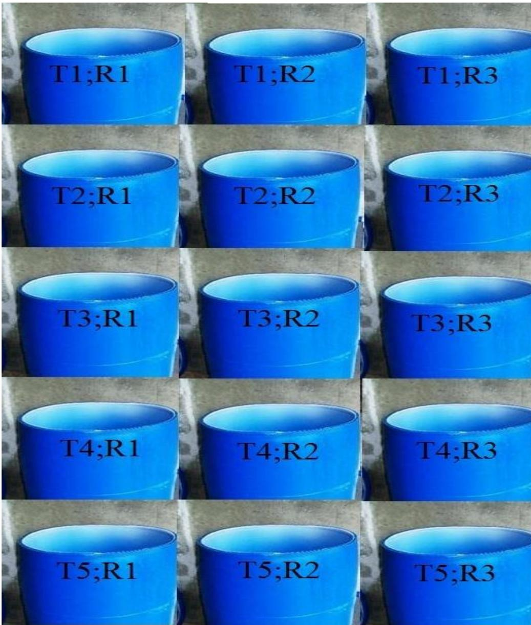
Figura 1 – Disposição dos reatores utilizados no experimento de compostagem aeróbica do lodo de fossa séptica (SFS) e resíduos sólidos de fumo (RSF).
