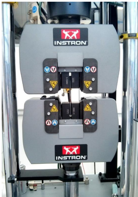
Figura 23 – Fotografia mostrando a máquina universal de ensaios mecânicos Instron 300LX-J3, em operação de ensaio a frio.
