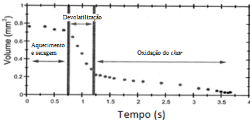
Figura 6 - Processo de combustão de pequenas partículas de biomassa em distintos estágios.
