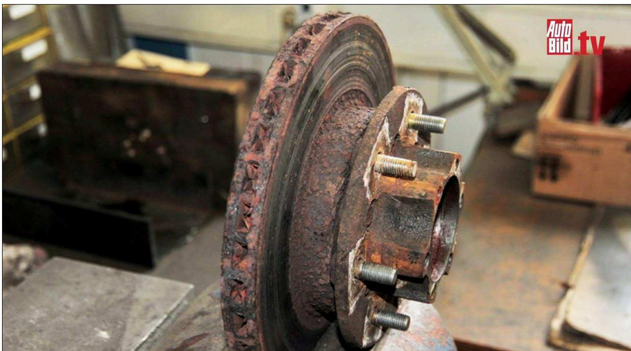
Figura 3: freio em estado avançado de deterioração. (fonte: adaptado de: <<http://www.carscoops.com/2014/10/watch-german-owner-kill-his-chinese-bmw.html>>)
