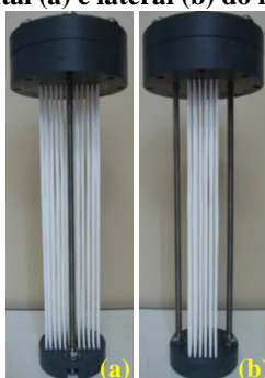
Figura 3. 3 - Imagens frontal (a) e lateral (b) do módulo de membranas.
