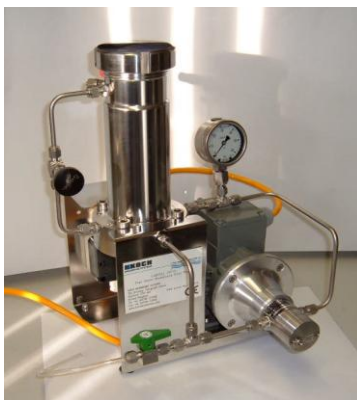
Figura 3.17 - Unidade de nanofiltração para pós-tratamento do efluente gerado pelo BRM.
