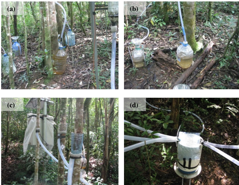
Figura 3-4 Monitoramento do escoamento pelo tronco: (a) recipiente de armazenamento cheio; (b) recipiente de armazenamento; (c) coletor do tipo espiral; e (d) ligação das árvores para o pluviógrafo.
