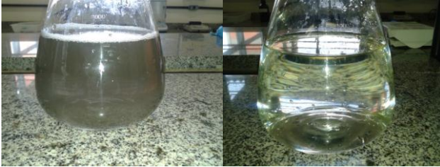
Figura 16: Aspecto visual da suspensão de 4-clorofenol com Nanofer 25S e após filtração com membrana 0,45 micrômetros.
