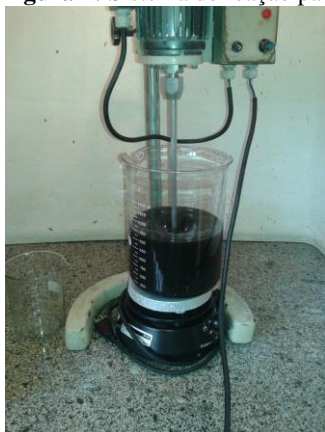
Figura 7: Sistema de reação para teste de redução do 4-clorofenol
