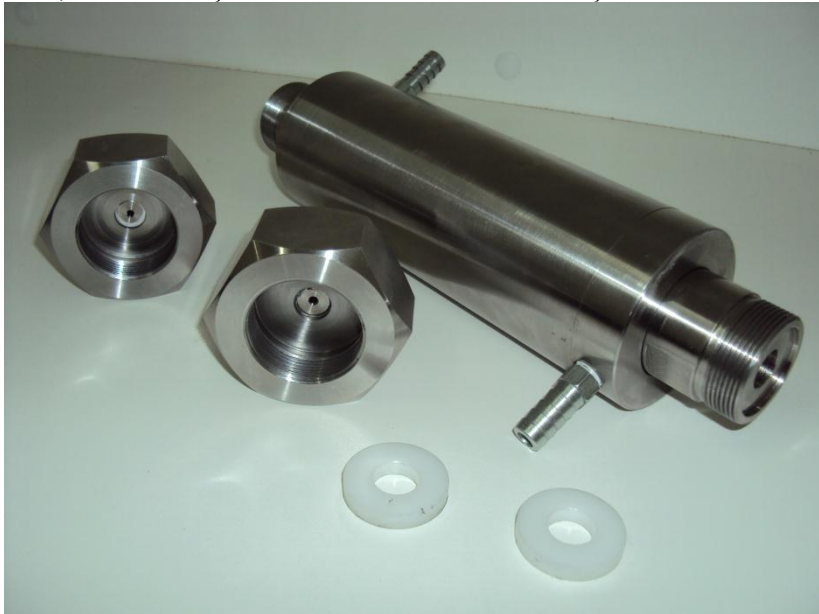
Figura 4.6: Coluna de extração e tampas usinadas em aço inoxidável 316L, camisa em aço inoxidável 304 e anéis de vedação em teflon.
