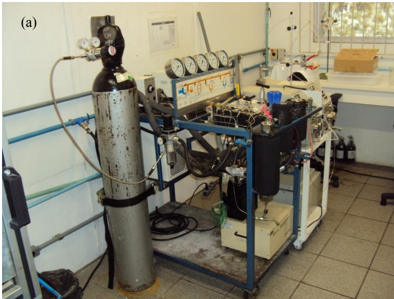
Figura 3.1: Equipamento de Extração Supercrítica (ESC) do LATESC. Vista lateral esquerda (a) e vista lateral direita (b).
