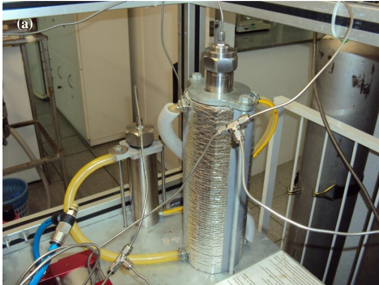
Figura 4.14: Colunas C-1 e C-2 montados na ESC - (a) saída das colunas; (b) entrada das colunas.
