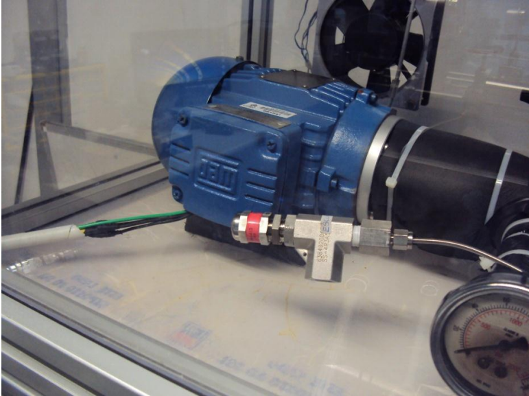
Figura 4.7: Calibração de abertura da válvula de segurança.
