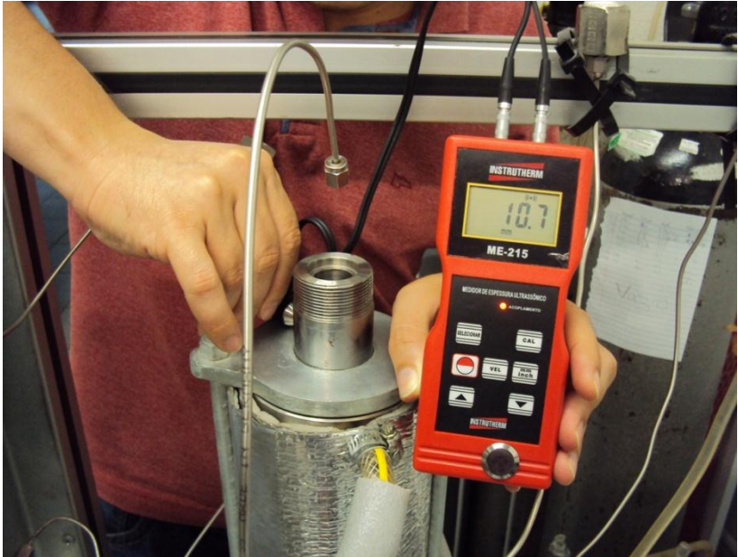
Figura 3.5: Medição de espessura por equipamento ultrassônico em diferentes pontos da coluna de extração.
