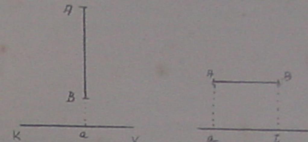
Si a recta  $AB$  fôr paralela á KV, sua projeção ab sobre KV lhe será igual.
