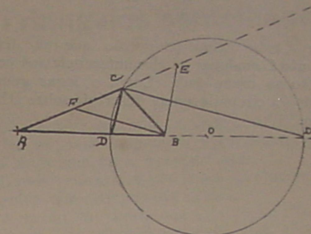
Com efeito, unindo CA, CD, CB, CD', e pelo ponto B, traçando BE paralela a CD, essas paralelas nos fornecerão as proporções:
