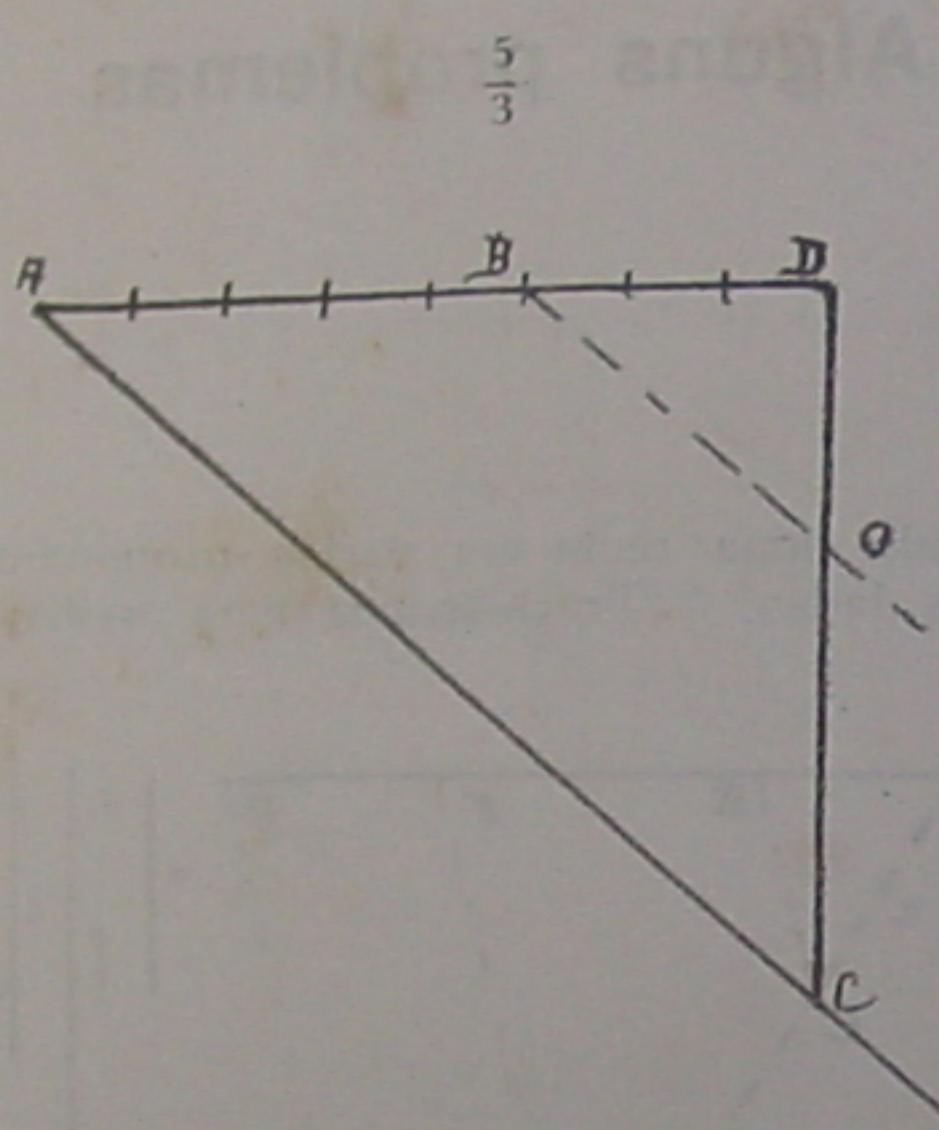
Pelo ponto O, traça-se OB paralela a AC: divide-se AB em 5 partes iguais e marca-se 3 d'estas partes a partir de B.
