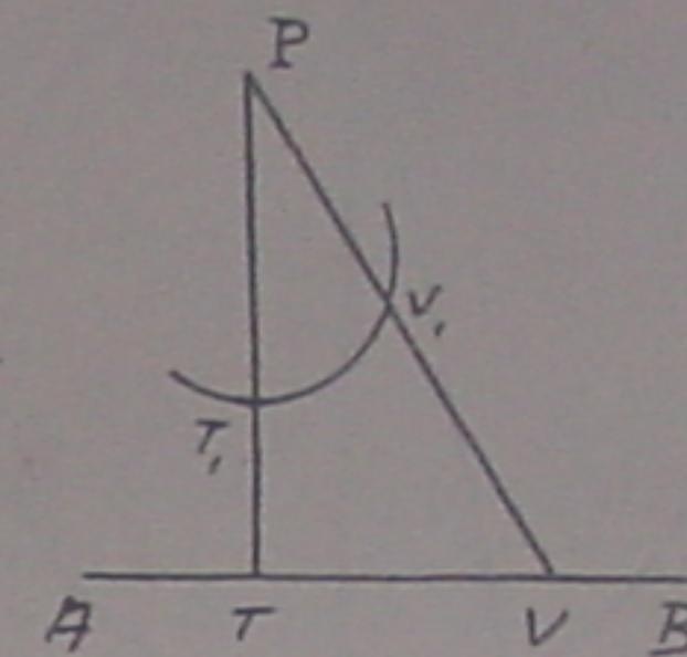
Sejam a recta AB, um polo P, e K a potencia de inversão. Unamos o ponto P a um ponto qualquer V da recta, tracemos PT perpendicular sobre AB e tomemos os pontos V<sub>1</sub> e T<sub>1</sub> taes que
