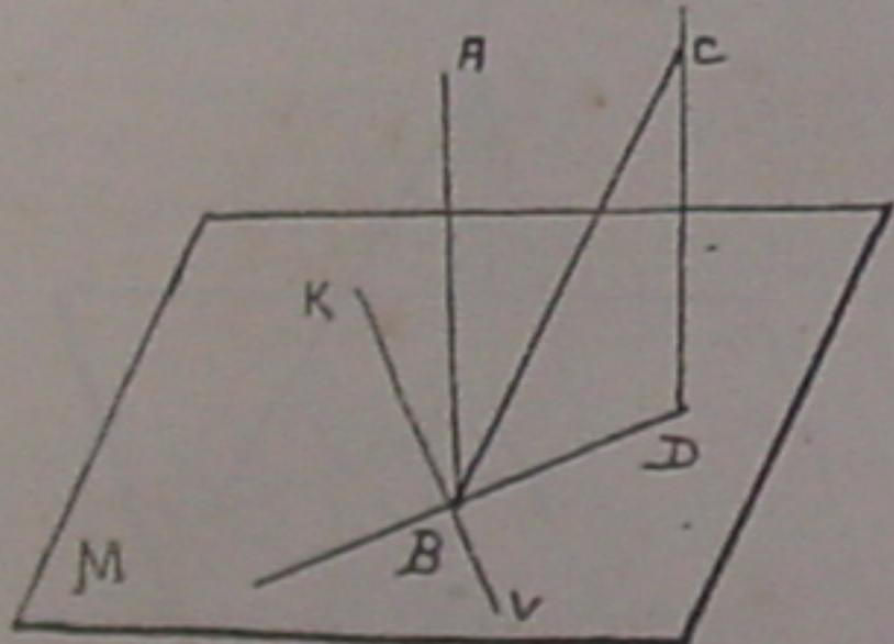
Tracemos no plano M a perpendicular KV à recta BD que une os traços das rectas CD e AB.
