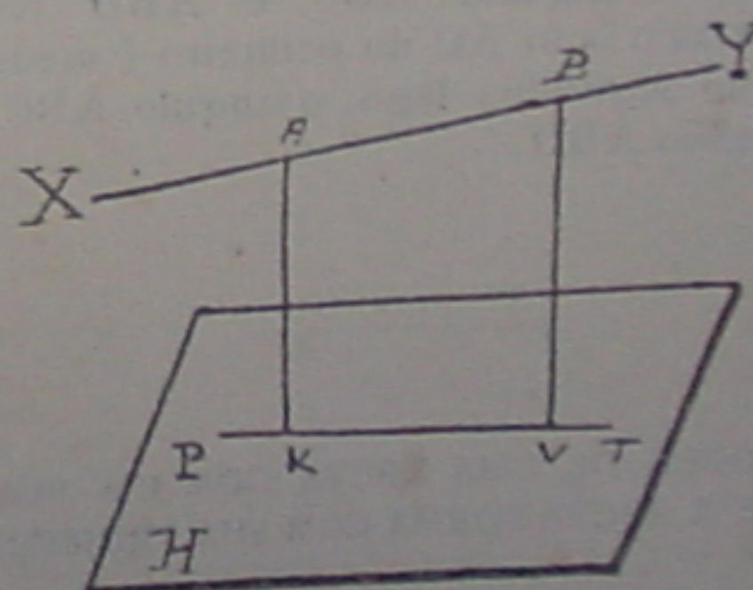
A projectante d'un ponto qualquer  $B$  da recta  $XY$  estará inteiramente contida n'esse plano, e, logo, terá o seu pé  $V$ , sobre  $PT$ . Esta recta  $PT$ , contendo as projecções de todos os pontos de  $XY$ , será a projecção de  $XY$  sobre o plano  $H$ .
