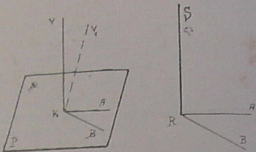
Seja o plano  $P$  e um ponto  $K$  neste plano. Considerando uma recta  $RS$  fóra do plano, e do ponto  $R$  desta recta, traçando as perpendiculares  $RA$  e  $RB$  em direcções diferentes, a recta  $RS$  considerada será perpendicular ao plano formado por  $RA$  e  $RB$ .
