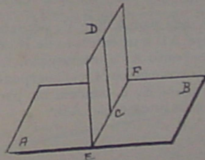
Por um ponto D do plano DEF perpendicular ao plano AB, traço DC perpendicular ao plano AB: esta perpendicular deverá coincidir com a perpendicular traçada do ponto D sobre EF, pois, esta ultima é perpendicular ao plano AB; logo, DC acha-se inteiramente contida no plano DEF.
