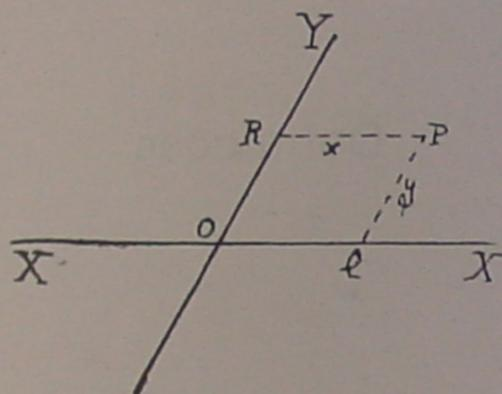
A posição d'um ponto P qualquer estará perfeitamente determinada pelas paralelas PQ e PR aos eixos Y e X. PQ ou y chama-se a ORDENADA e PR ou x chama-se ABCISSA. Os segmentos x e y são as COORDENADAS do ponto P.
