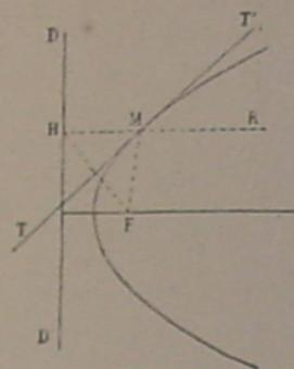
Tendo traçado o raio vector FM e a recta MH perpendicular sobre a directriz DD', basta traçar a bissectriz do angulo HMF. será a tangente á parabola no ponto M.
