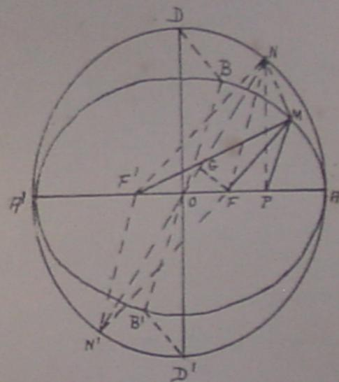
Do ponto F, tracemos a perpendicular FG sobre o diametro NN', e unamos NF e NF'. A linha NM é perpendicular ás rectas MP, MF, MF', que passam pelo seu pé M e estão no plano de projecção. Os triangulos rectangulos DBO e NMP são semelhantes, porque seus lados são respectivamente parallelos: logo, temos:
