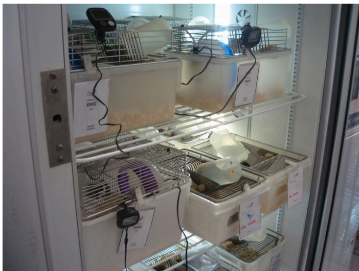
Figura 3: Gaiolas com rodas de correr acopladas utilizadas no protocolo experimental. (Fonte: Arquivos do autor).
