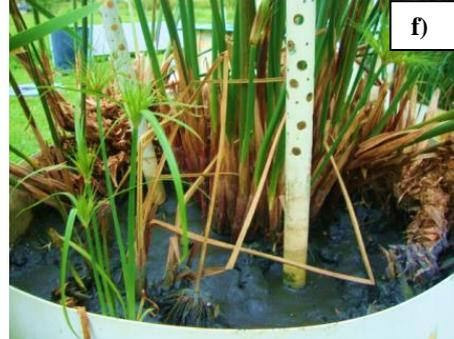
No período de repouso de sete dias (tempo de detenção hidráulica na UE) ocorria o desaguamento do lodo em WT e WP (Figura 11 e-f).
