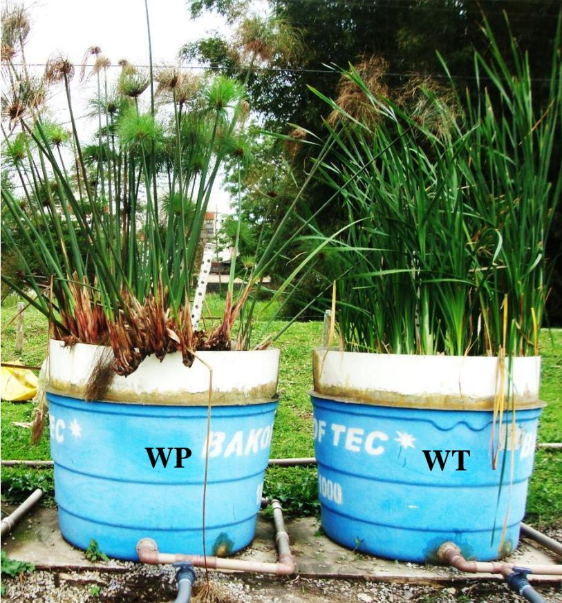
A UE foi construída em 2009, conforme descrito em Magri *et al.* (2011), para avaliar o desempenho no desaguamento de lodo anaeróbio, com foco no comportamento de diferentes espécies de macrófitas e diferentes taxas de aplicação superficial.
