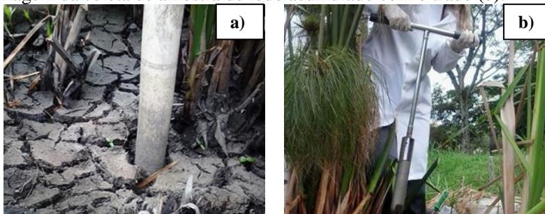
Para cada coleta o local de amostragem era escolhido aleatoriamente e os buracos de aproximadamente 20 mm resultantes das coletas eram preenchidos com lodo da superfície do WCL para evitar ao máximo interferências no processo de estabilização ou inativação de microrganismos patogênicos e caminhos preferenciais para a água da chuva.
