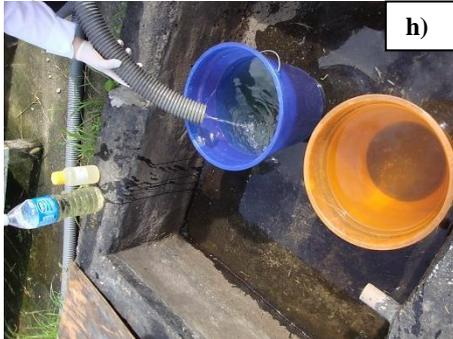
Para obter melhores resultados, pequenas alíquotas dos percolados eram coletadas a cada minuto em baldes previamente esterilizados com álcool 70% para garantir uma amostra composta (Figura 11 h). As amostras eram coletadas em frascos específicos, previamente autoclavados, posteriormente acondicionadas em sacola térmica e encaminhadas para análise. A UE permanecia aberta por 24h para que a maior parte do líquido percolasse dos WCL.
