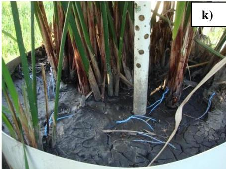
Então 24h depois da coleta do  $LP_2$ , os registros da UE eram fechados e iniciava-se um novo ciclo. O lodo era removido outra vez do TS, acondicionado no TA e a UE era alimentada novamente, sendo o lodo de alimentação lançado sobre o lodo que ficou acumulado na superfície de cada WCL no ciclo anterior (Figura 11 k). Cada ciclo tinha duração de três semanas.
