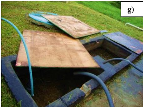
**7º Dia:** Após esses sete dias de detenção hidráulica, o efluente líquido resultante do desaguamento do lodo na UE ( $LP_1$ ) era encaminhado por gravidade para as caixas coletoras de líquido percolado (Figura 11 g). Nestas caixas os líquidos percolados de WT e WP eram armazenados separadamente com o objetivo de caracterizá-los qualitativa e quantitativamente.
