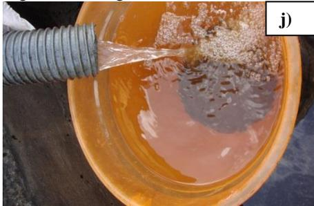
**15º Dia:** Após mais sete dias de detenção os registros da UE eram abertos e coletava-se então o efluente da recirculação ( $LP_2$ ) de cada WCL, o qual era o efluente final do processo de tratamento do lodo (Figura 11 j). Após a coleta do  $LP_2$  os registros dos WCL permaneciam abertos durante 24h para que possíveis líquidos percolados após a coleta do efluente final fossem drenados do sistema.
