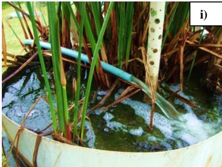
**8º Dia:** Fechava-se a UE e retirava-se a maior parte do líquido ainda acondicionado na mangueira devido às irregularidades do solo. Após estes procedimentos, com auxílio de bomba submersível (Schneider®, BCS 2000) o LP<sub>1</sub> era recirculado para as superfícies dos respectivos WCL da UE (Figura 11 i).
