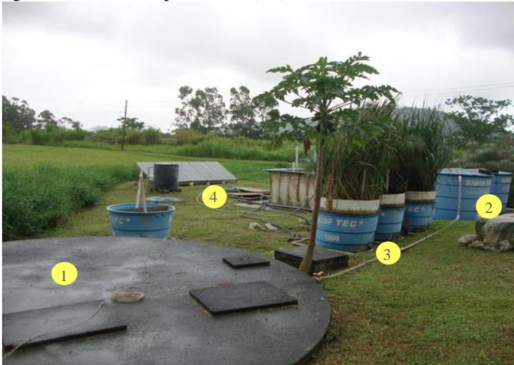
(1) Tanque séptico, (2) Tanque de armazenamento de lodo, (3) Unidade experimental (WT e WP), (4) Caixas de recebimento do líquido percolado.
