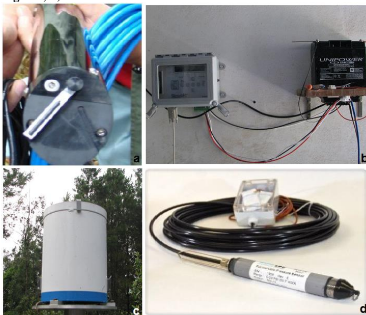
Figura 6 – Equipamentos utilizados para monitoramento no exutório da bacia hidrográfica do Rio Negrinho. a) turbidímetro; b) datalogger; c) pluviôgrafo; d) sensor de nível.
