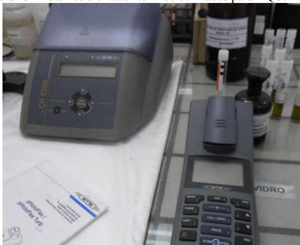
Figura 13 - Fotômetro e reator térmico utilizados para DQO.
