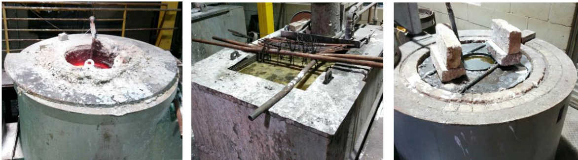
Figura 3.2 - Fornos utilizados na realização dos experimentos de tratamentos térmicos nas etapas de: (a) austenitização, (b) martêmpera, (c) partição.
