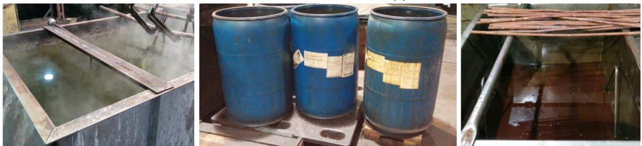
Figura 3.3 - Procedimento de limpeza após tratamento térmico. (a) água a quente (b) solução aquosa de ácido muriático e neutralizante, (c) óleo.
