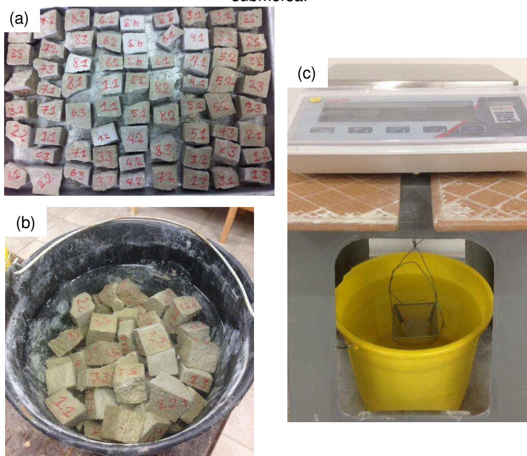
Figura 19 - (a) fragmentos avaliados, (b) imersão em água por 72h e (c) pesagem submersa.
