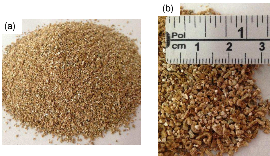
Figura 13 - (a) vermiculita utilizada e (b) sua imagem ampliada.
