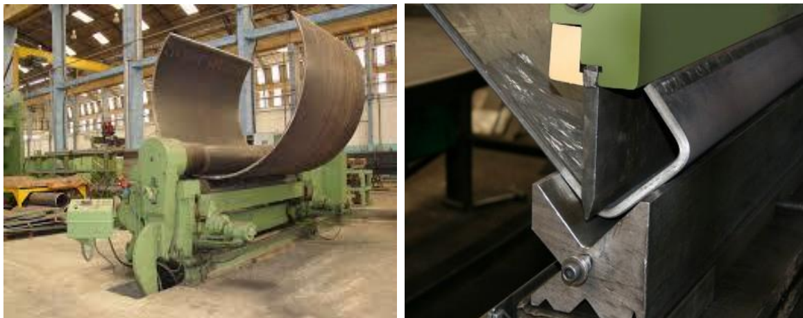
Figura 25 - Processos de dobra do aço
