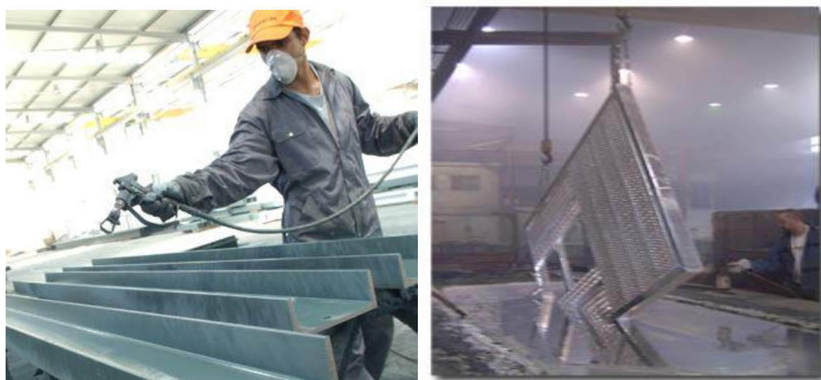
Figura 33 - Pintura e galvanização
